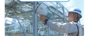
リークディテクターによる エア漏れ箇所の特定
