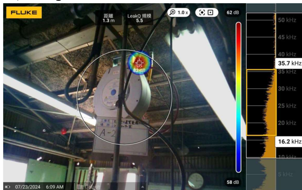
エアガン ホースリール部からの圧縮空気漏れ
